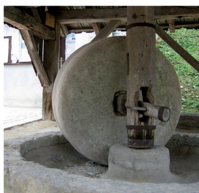
On écrasait le chanvre dans un dispositif destiné à briser les tiges pour assouplir les fibres. Les fibres étaient ensuite filées puis tissées ou transformées en cordages.
