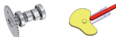
Ils font partie des commandes des machines mécaniques: cames des décolleteuses, arbres à cames des moteurs d'automobiles, cylindres des boîtes à musique et d'autres encore !
