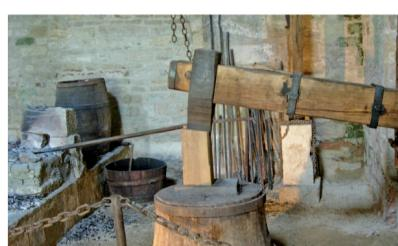
Les taillanderies, d'où sortaient des haches, des pioches, d'autres outils dépendaient du bon fonctionnement d'un martinet. Un martinet est encore en activité à Corcelles.
