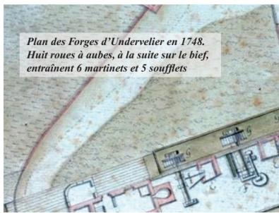
Plan des Forges d'Undervelier en 1748. Huit roues à aubes, à la suite sur le bief, entraînent 6 martinets et 5 soufflets
