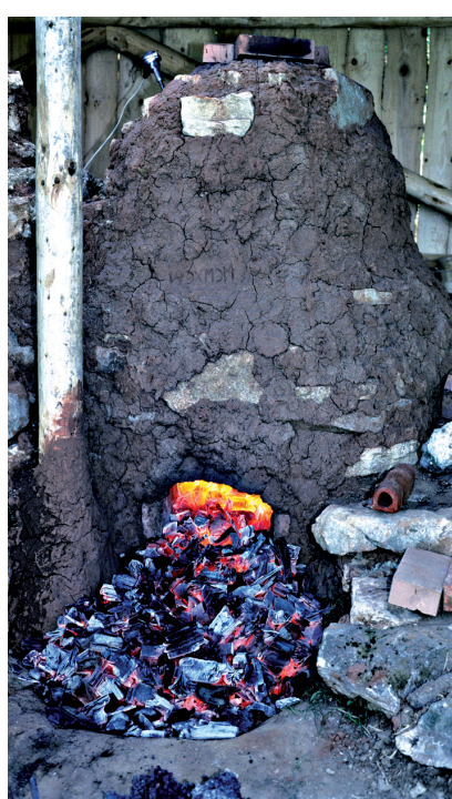
Réduction du minerai de fer en bas fourneau à tirage naturel (reconstitution...)
